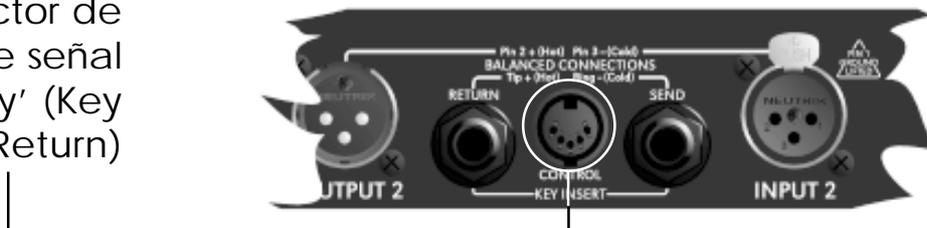
Si pulsamos el conmutador 'Key Ext', la señal de entrada de este conector balanceado es la señal de 'key' que va a utilizar el DPR 522 como señal de disparo de la puerta. Este conector se puede usar como retorno de la señal ya procesada que se mandó a un equipo externo por el conector de envío de señal de 'key' o bien como entrada de cualquier otro tipo de señal. Más detalles sobre este conector aparecen en la sección 5.4.
