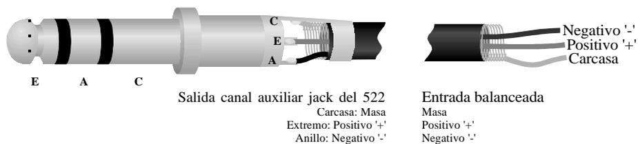
La conexión de equipos con entradas no balanceadas se debe realizar conectando la punta del conector con la señal del cable y el anillo a la malla. Destacar que la malla del cable de salida del DPR 522 puede o no conectarse a la masa del equipo destino en la conexión de entrada.
