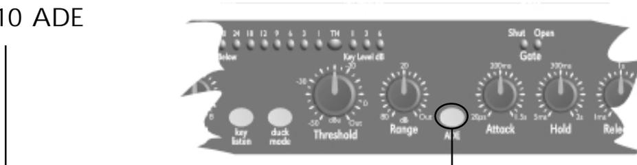
La Envolvente Automática de la Dinámica (*Auto Dynamic Envelope*) es una técnica diseñada por BSS para ayudar a restablecer la transiente de la señal que pasa a través de la puerta. Como hemos visto antes, suele ser necesario usar un tiempo de ataque mayor que el tiempo de ataque ideal, aunque perdemos parte de señal, al no seguir correctamente la transición inicial de la señal.
