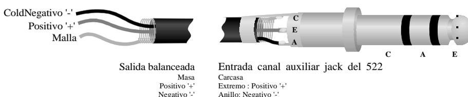
Cuando alimentamos el DPR 522 con señales no balanceadas, tenemos que conectar la señal a la punta del jack, y la malla del cable al anillo y a la carcasa del jack.
