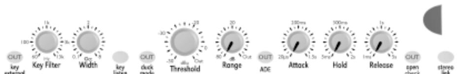
Ajustar el control de filtro de señal de 'key' a 1kHz y el control de ancho del filtro a 8 octavas. Si aplicamos señal a la entrada principal y conectamos el botón de escucha de la señal de 'key', podemos escuchar el programa. Girando el control de ancho podemos comprobar cómo varía la composición en frecuencia del sonido (según giramos el control en el sentido contrario a las agujas del reloj, limitamos más la respuesta en frecuencia).
