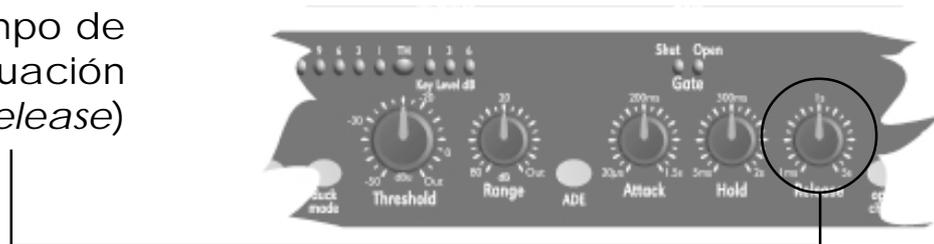
Esta es la última fase de la respuesta dinámica y se produce después que el tiempo de mantenimiento ha finalizado. Al terminar el tiempo de 'Release' seleccionado, la señal debe estar atenuada en la cantidad que indica el potenciómetro y de forma logarítmica. Esto hace que se produzca una transición de nivel natural, esencial sobre todo para largos tiempos de 'release'.
