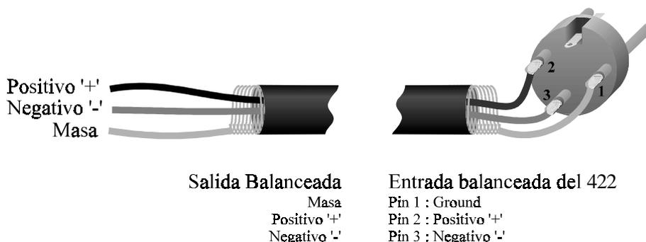
Cuando la señal de entrada viene de fuentes no balanceadas, se conecta la señal del cable al pin 2 y la malla del cable a los pins 1 y 3. Las conexiones de entrada aisladas mediante transformador es una opción indicada por el distribuidor.
