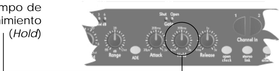
Una vez que termina el tiempo de ataque, el DPR 522 mantiene la puerta abierta por un tiempo controlado mediante el potenciómetro 'Hold', lo que evita que el DPR 522 tenga que comenzar de nuevo la secuencia de ataque si aparece una caída momentánea de la señal de entrada por debajo del umbral.
