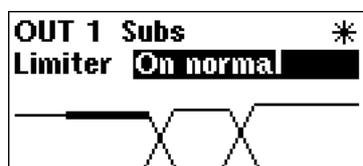
Los limitadores se pueden ajustar a los siguientes valores: 'ON NORMAL' y 'ON FAST'. Si seleccionamos el más rápido, el tiempo de ataque será menor. También se puede desactivar la función de protección del limitador girando la rueda de selección en el sentido contrario de las agujas del reloj hasta la posición 'OFF'. Cuando llevamos los limitadores a esa posición, el LED rojo 'OVER' se ilumina en señal de advertencia.
