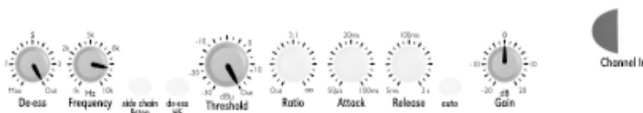
Giraremos gradualmente en el sentido contrario a las agujas del reloj el control *De-ess* hasta que obtengamos el resultado deseado. El control de frecuencia también se puede ajustar de tal manera que las frecuencias que están por debajo de la que nos causa el problema no desaparezcan el filtro atenuador. Es importante destacar que se debe recordar que este tipo de filtrado de banda ancha puede provocar distorsión o efecto 'pumping' si el programa tiene mucha componente de baja frecuencia.
