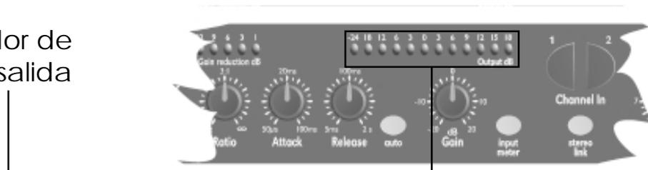
Este indicador muestra el nivel de señal de salida del DPR 422 y da una completa lectura de ese nivel. Si en el panel posterior el nivel de operación está en la posición +4dBu, este indicador medirá con precisión la señal en dBu. Si por el contrario, está en la posición -10dBV, el indicador medirá la señal en dB tomando como nivel de referencia -14dBV.
