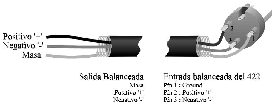
Cuando la señal de entrada viene de fuentes no balanceadas, se conecta la señal del cable al pin 2 y la malla del cable a los pines **1 y 3**. Las conexiones de entrada aisladas mediante transformador es una opción indicada por el distribuidor.
