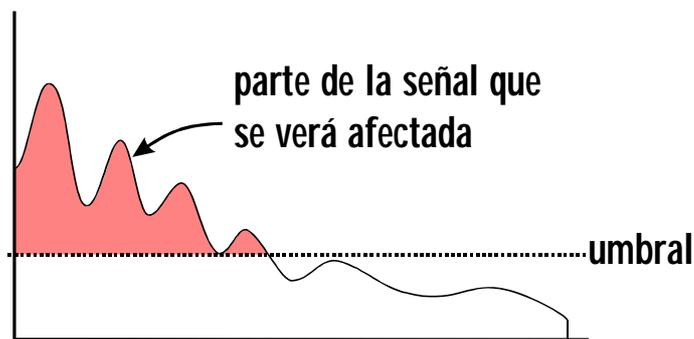
asumiendo que todos los demás controles en ambos canales están ajustados idénticamente con igual ganancia, es aparente que la señal procesada con el nivel mas alto se dice que ha sido limitada, mientras que la señal con el nivel mas bajo se dice que ha sido comprimida.
