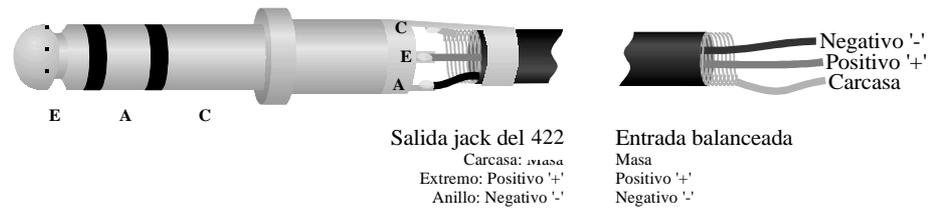
La conexión con equipos con entradas no balanceadas se debe realizar conectando el extremo de la espiga a la señal del cable, y el anillo a la malla del cable. La malla del cable de salida del DPR 422 puede o no conectarse a la masa del equipo destino en la conexión de entrada.
