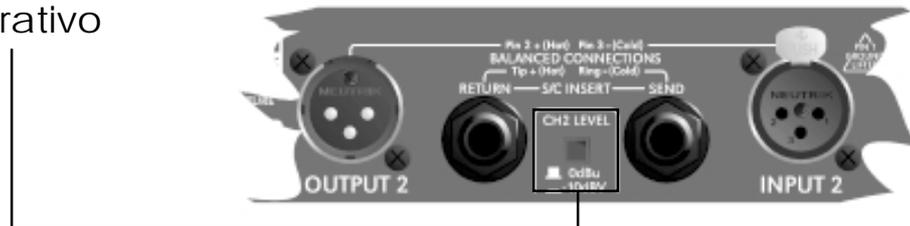
Ajustando este interruptor del panel posterior configuramos el equipo a un nivel de +4dBu para aplicaciones en sistemas profesionales. El control de umbral (threshold) y el indicador de nivel de salida tendrán una lectura en dB con base a 0dBu, y los puntos de inserción del canal auxiliar se adecuarán a los requerimientos de nivel de señal de sistemas profesionales.
