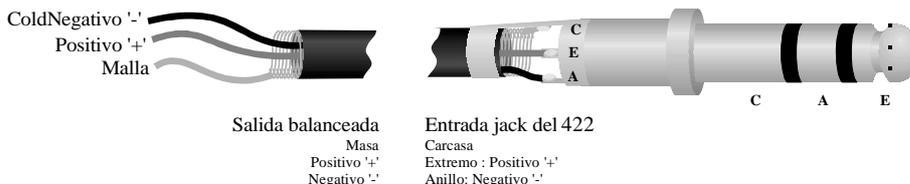
Cuando alimentamos el DPR 422 con señales no balanceadas, tenemos que conectar la señal al extremo de la espiga del jack y la malla del cable al anillo y a la carcasa del jack.
